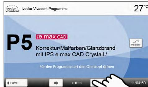
Durch Drücken des **[Parameter]**-Buttons kann in die Programm-Parameter-Anzeige gewechselt werden. In dieser können Programm-Parameter editiert werden.
